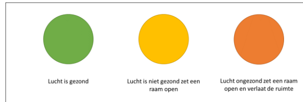
Figuur 7 Voorbeeld van een waarschuwingssysteem op basis van de data en vooraf ingestelde setpoints.
